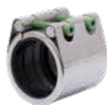
Serie 745/20 Repico® slip kopling Universal og ikke strekkfast til alle rørtyper Rustfritt stål AISI 316 NBR eller EPDM pakning DN15-400
