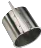
Serie 05 Støttehylse til PE-rør Egnet til bruk sammen med Supa Maxi™, Supa Plus™, Hymax og combiflenser Rustfritt stål DN50-400 PN6.3/10/16 SDR 11/17
