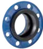
Serie 05 Combiflens til PE- og PVC-rør Strekkfast Duktiljern/EPDM DN50-300 (PE-rør max DN150) PN10/16
